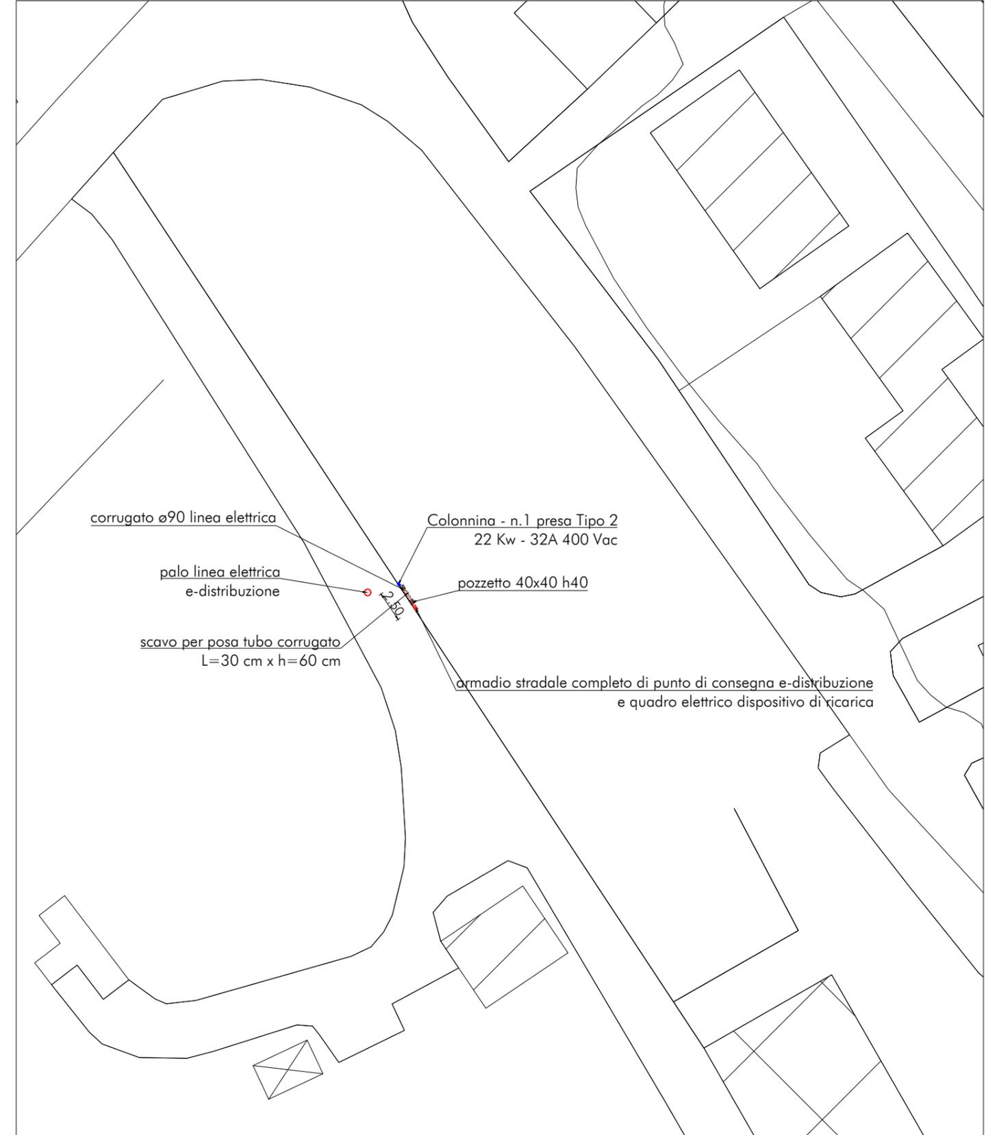
**Particolare Colonnina - n. 1 presa Tipo 2, 22 Kw**
